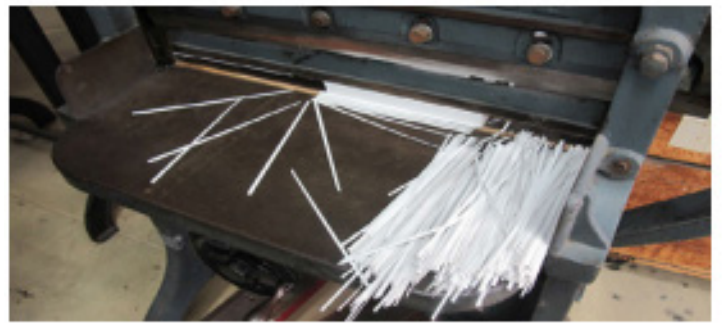
切割机。书籍被压床压住，放在它的台子上，金属刀垂直放下，并切割掉多余部分
